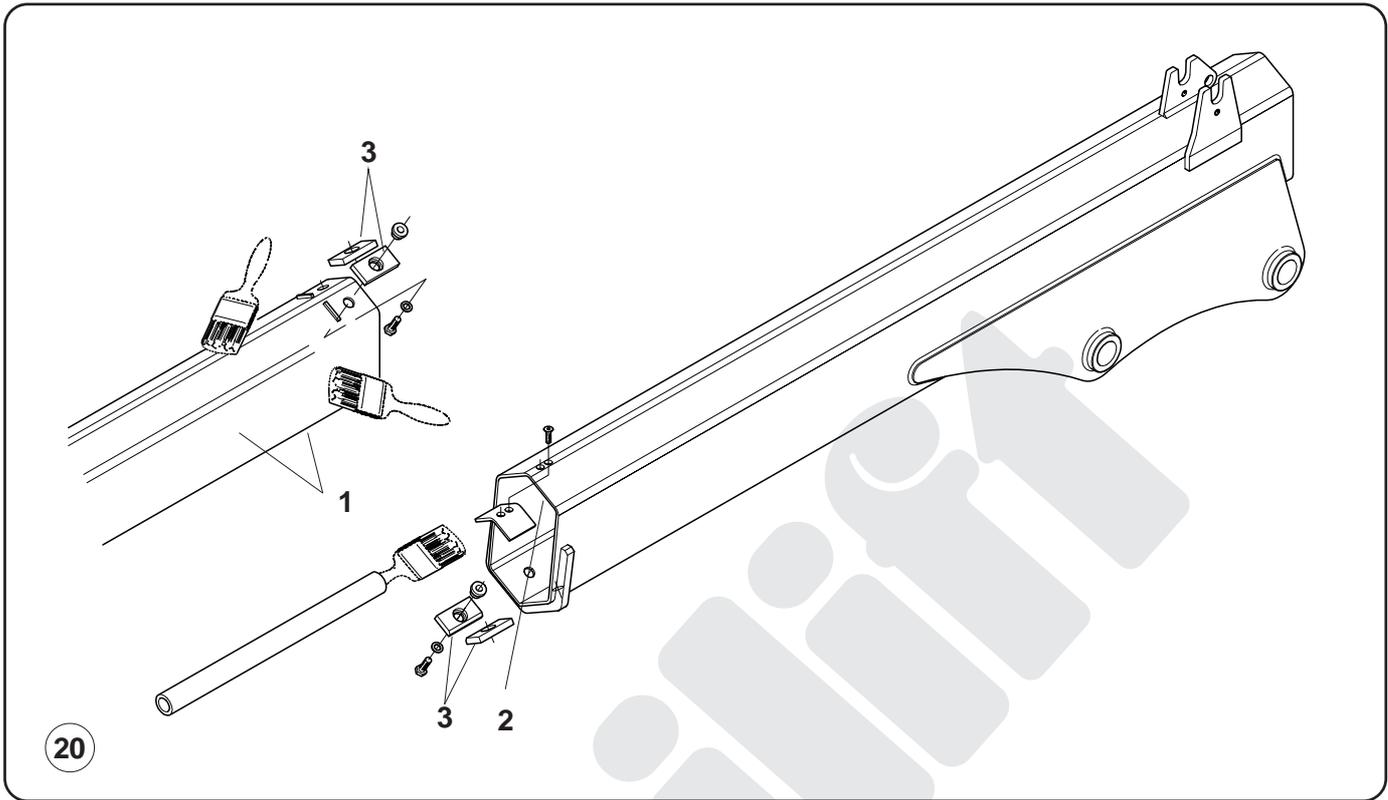
9.4.6 Controllo del riduttore del gruppo a vite senza fine
